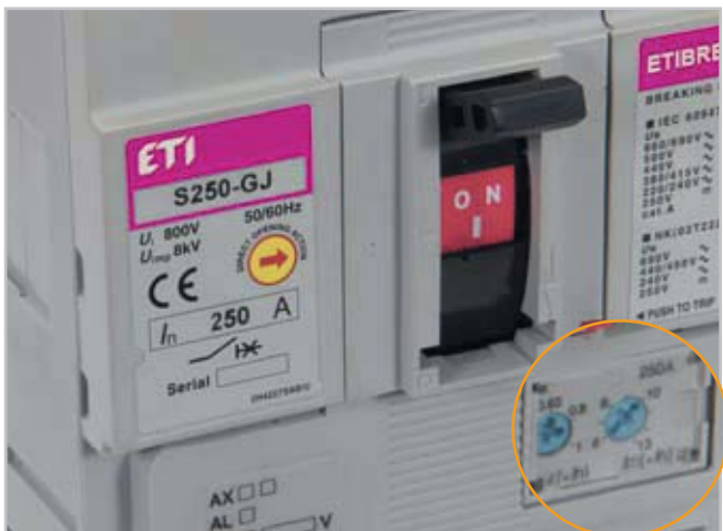
3-х полюсный автоматический выключатель с настраиваемой тепловой и электромагнитной уставкой.
